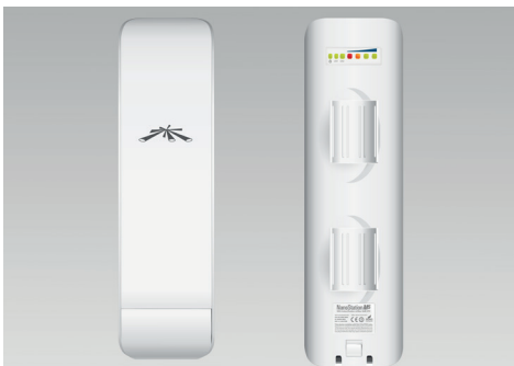
Vorderseite, Ausrichtung zum Sender Rückseite, „RSSI“ LED Zeile ist oben
